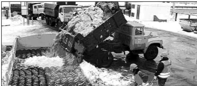
Рис. 7. Выгрузка снега в приёмный бункер сепаратора-дробилки стационарной снеготаялки
